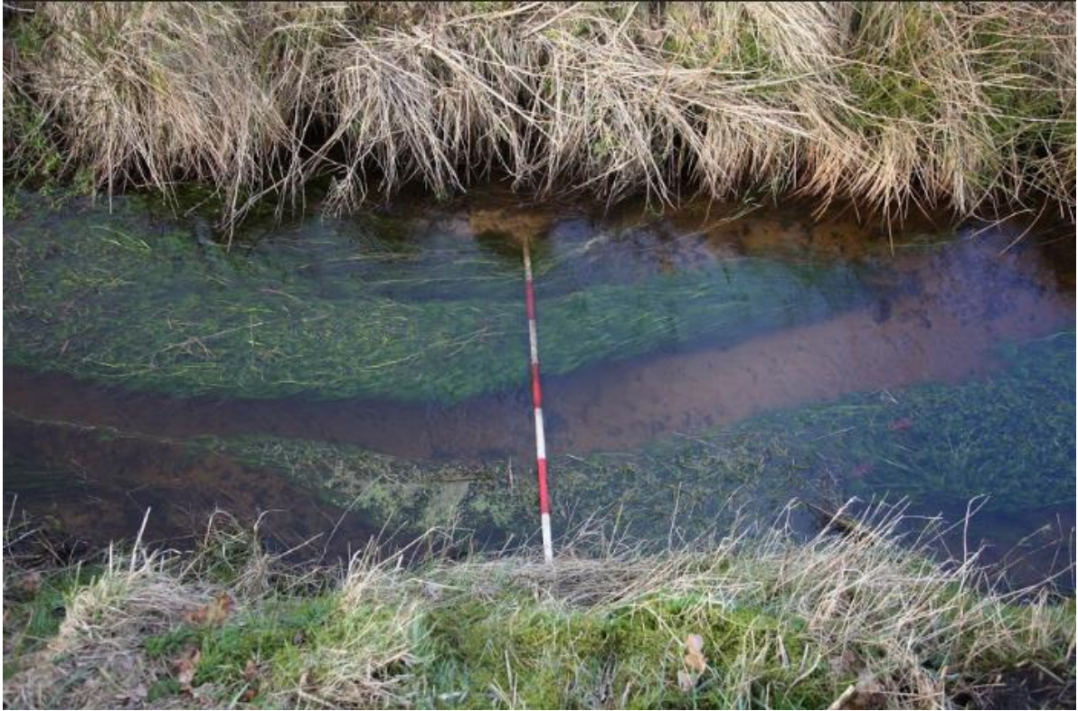
Figur 12 Høllet Bæk. På billedet øverst ses en veldefineret strømrende omkring st. 3.000 m. Farveskalaen på landmålerstokken er inddelt i 20 cm's sektioner.
